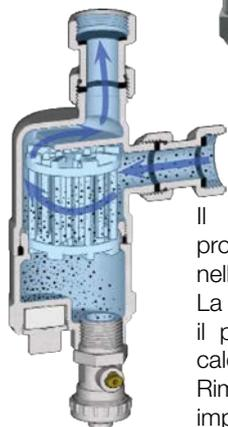
Il nuovo defangatore CompactFAR è studiato per proteggere le caldaie murali dalle impurità presenti nell'impianto. La cartuccia interna consente di separare le impurità e il particolato metallico che potrebbero danneggiare la caldaia. Rimuovendo l'inserto magnetico è possibile scaricare le impurità raccolte.
