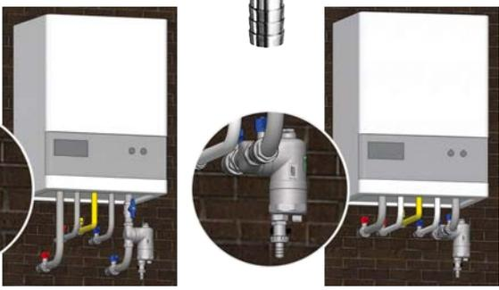
Il defangatore compatto orientabile è adatto all'installazione su tubazioni con disposizione verticale ed orizzontale, in quanto la parte con gli attacchi filettati può ruotare di 360° attorno al proprio asse.
